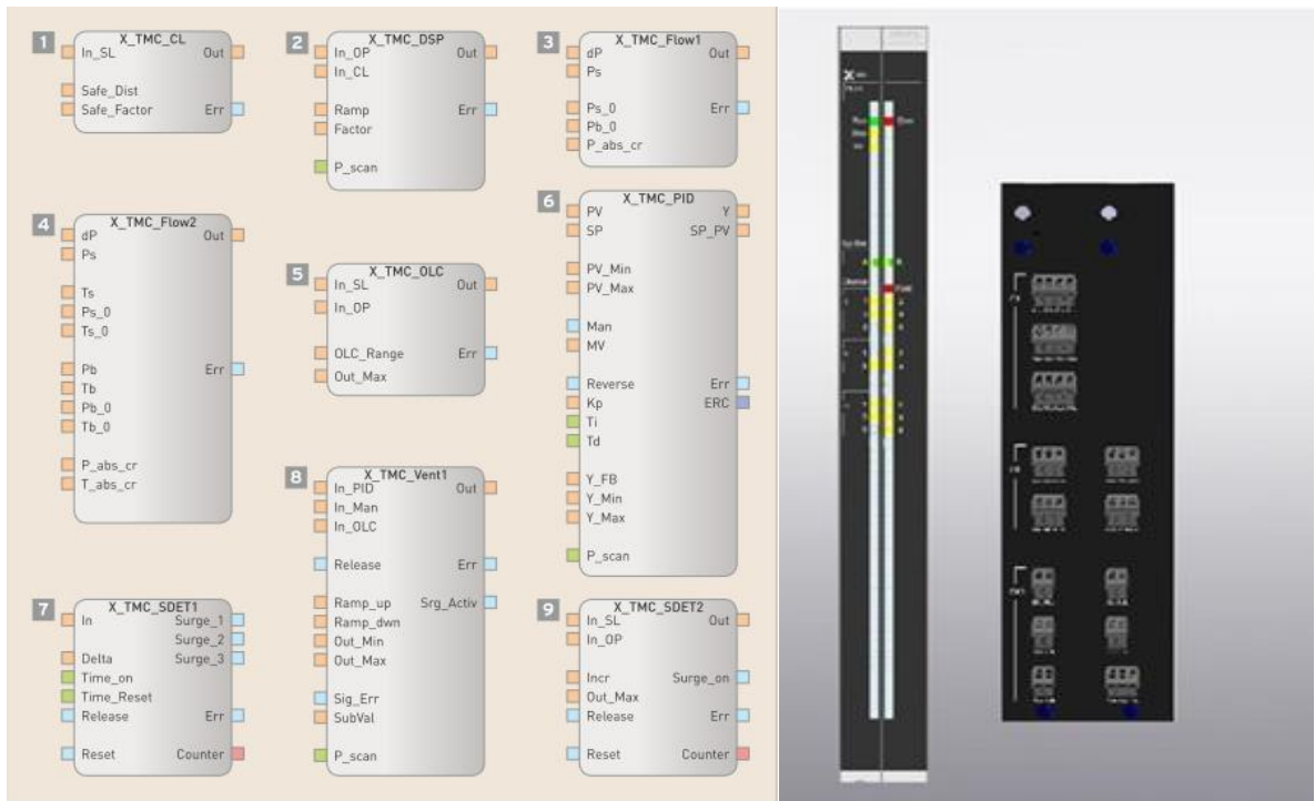
2.12 Сурет – Функция блоктары (FBD) (сол жақта). Жеке Siemens үдеткіштен қорғау модулі (оң жақта)
