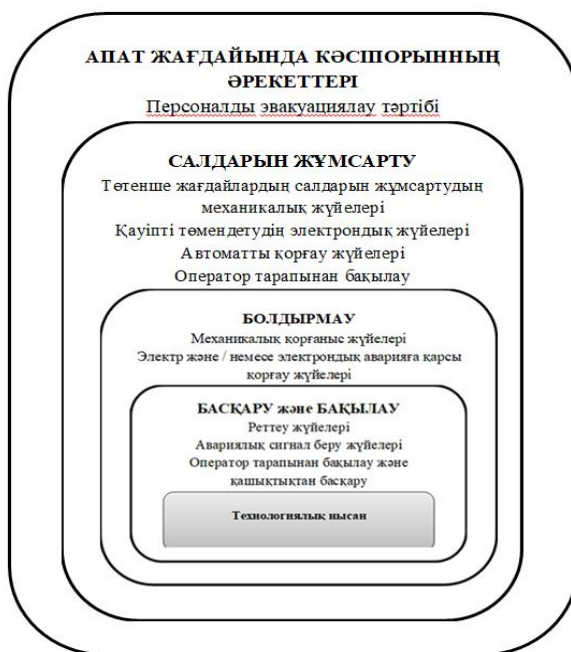
1.6 Сурет – Мұнай-газ өндіру объектілерінде тәуекелдерді төмендету үшін қолданылатын қорғаныстың типтік қабаттары және қауіпсіздік функциялары
