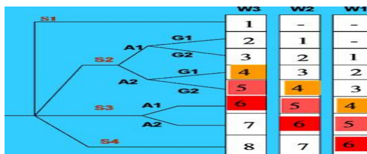
1.7 Сурет – Қауіпсіздік деңгейлері SIL және акт талап етілетін қауіпсіздік сыныптары, тәуекел және жарақаттану параметрлері
